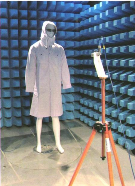
电磁辐射防护服装测试
