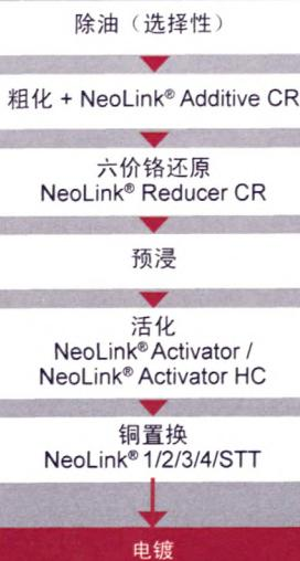
NeoLink® 工艺在塑料直接电镀领域迈出了关键的一步，在该领域具有里程碑式的意义。该工艺在最终电镀前仅需 5 个步骤，可在 ABS 和 ABS/PC 塑料上产生高且稳定的导电性，而且无需任何额外的化学镀或预镀。
