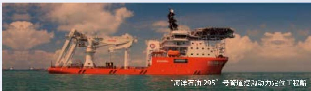
“海洋石油 295”号管道挖沟动力定位工程船
