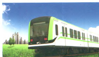
※ 储能式轻轨电车
