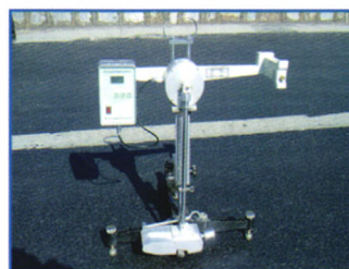
路面耐磨系数（摆式BPN）测试
