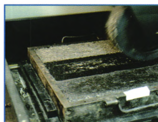
暴露轮碾试验
