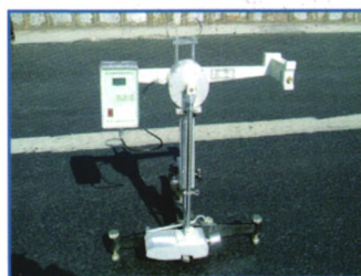
路面耐磨系数（摆式BPN）测试
