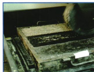
暴露轮碾试验
