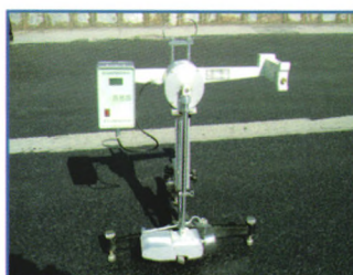
路面耐磨系数（摆式BPN）测试
