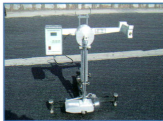
路面耐磨系数（摆式BPN）测试
