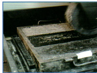
暴露轮碾试验
