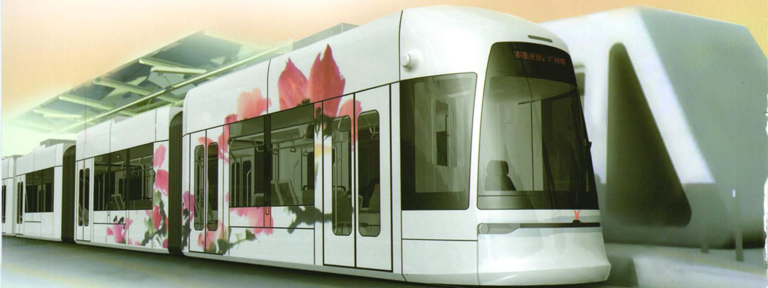
■ 全线无接触网运行 更经济 / 30 s 内快速充电 更效率 / 制动能量回馈 更节能 ■
