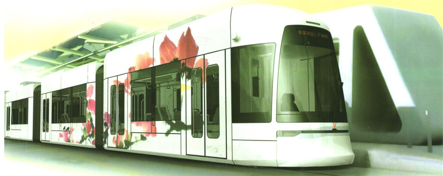
■ 全线无接触网运行 更经济 / 30 s 内快速充电 更效率 / 制动能量回馈 更节能 ■
