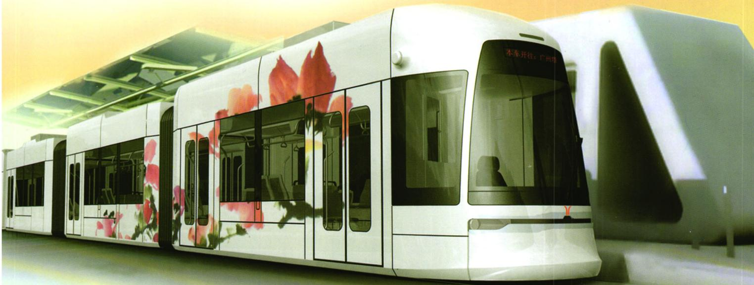
■ 全线无接触网运行 更经济 / 30 s 内快速充电 更效率 / 制动能量回馈 更节能 ■
