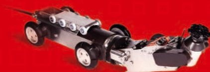
管道预处理设备
