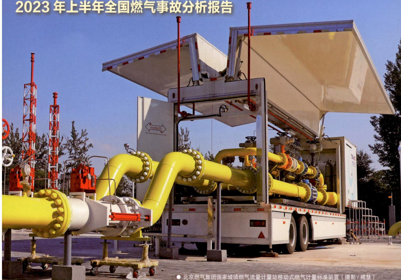
● 北京燃气集团国家城镇燃气流量计量站移动式燃气计量标准装置（摄影 / 揭慧）
