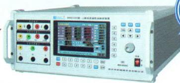
装置的核心技术是ARM+FPGA；高速高精度D/A转换器与直接数字合成技术（DDS）；高精度大功率精密运放；双重输出保护，高保真、高抗冲击能力。产品融交流采样器、交直流指示仪表、多功能电能表三大检定功能为一体。
