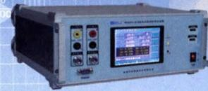
装置具有全自动检定：电压基本和综合误差，时钟误差（超上下限时间），报警电压测定，灵敏度测试，频率和谐波影响，负载、功耗、失真度测量，闭环控制、软件校准、自我保护，档案统计管理等功能；彩色触摸屏液晶显示，中文菜单方式；设有232、485和USB接口，支持鼠标操作和U盘存储数据。
