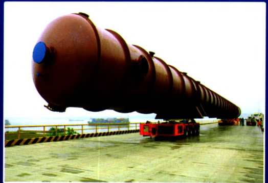
● 自主研发生产的液压组合挂车广泛应用于大型石化项目
