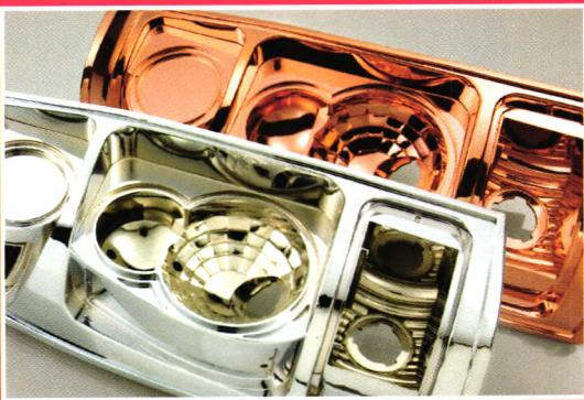
NeoLink® 工艺在塑料直接电镀领域迈出了关键的一步，在该领域具有里程碑式的意义。该工艺在最终电镀前仅需 5 个步骤，可在 ABS 和 ABS/PC 塑料上产生高且稳定的导电性，而且无需任何额外的化学镀或预镀。
