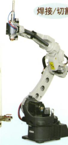
激光焊接机器人
