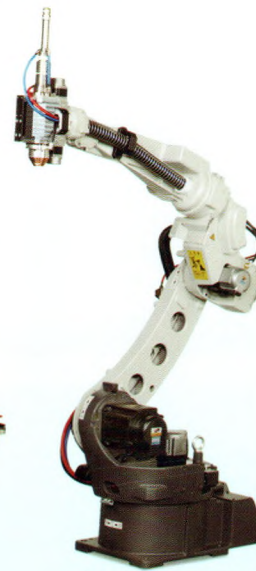
激光焊接机器人
