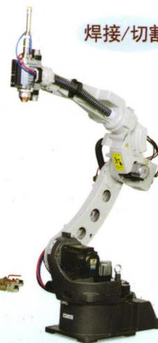
激光焊接机器人
