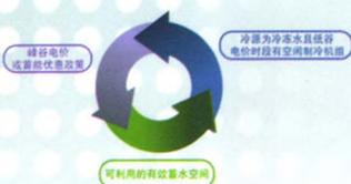
充分利用峰谷电价差，在低谷电时段将高峰时间所需的部分或者全部的冷量通过技术手段存储起来，在高峰时段释放冷量，减少电费支出。
