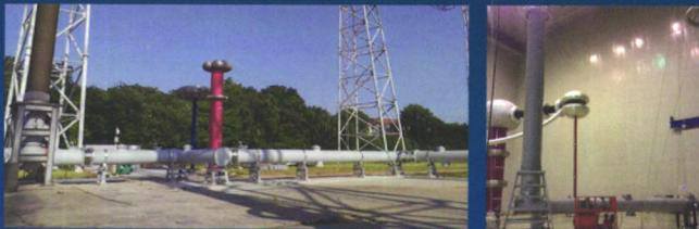
采用了氮气/六氟化硫混合气体作为绝缘介质，在国际上第一次将环保型混合气体应用于特高压气体绝缘线路，打破了国外在这一领域的技术垄断。
