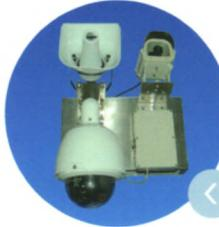
系统集成视频集成模块、雷达探测模块及智能分析仪，实时探测与监控输电线路通道内的运动物体，智能识别与分析其运动路径和范围对线路安全运行的影响，并对危险运动进行预警和报警。
