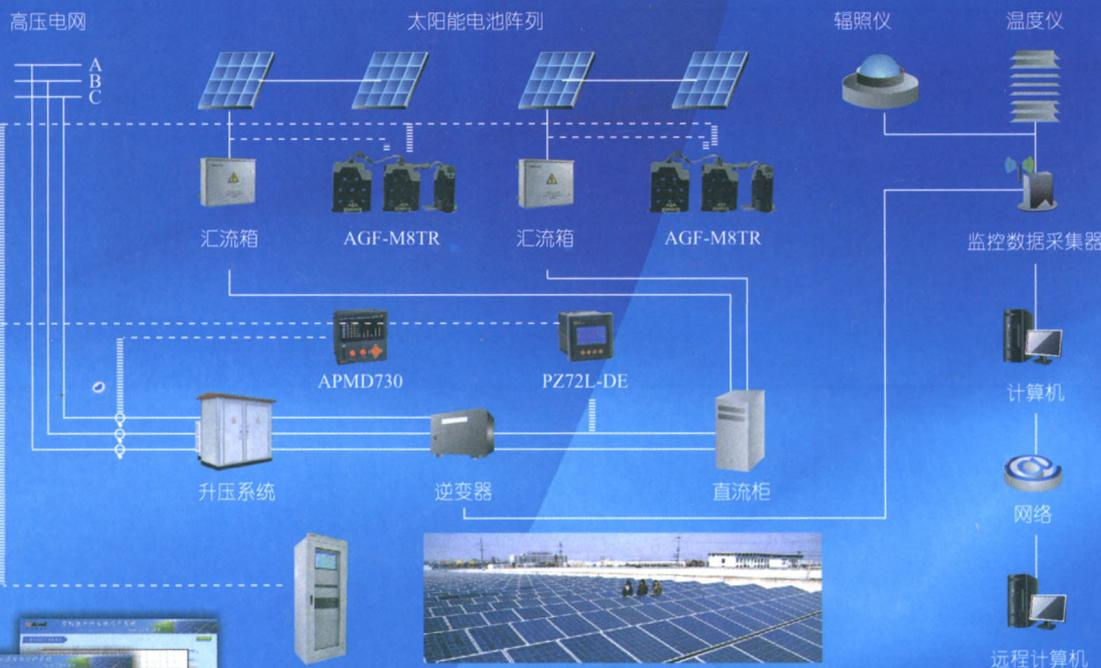
光伏电站电力监控系统采用AGF智能汇流采集装置、PZ直流多功能表及ACR电力仪表,对光伏电站中的电池阵列、汇流箱、逆变器、交直流配电柜等设备进行实时监测、分析和控制,从而掌握电站运行情况,系统有电能数据分析、电量采集、故障记录、环境监测、CO<sub>2</sub>减排等功能。
