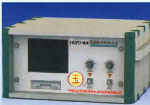
HRJFD现场数字局部放电检测分析系统 测量通道: 2通道 检测灵敏度: 0.1PC 测量频带: 3dB宽带10~300kHz 程控滤波器设置档位
