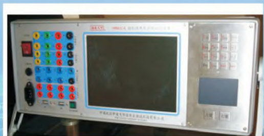
HRJFD现场数字局部放电检测分析系统 测量通道: 2通道 检测灵敏度: 0.1PC 测量频带: 3dB宽带10~300kHz 程控滤波器设置档位
