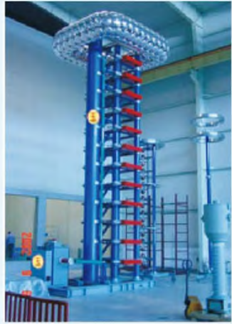
HRHG-1000~10000kV成套冲击电压发生器全自动试验装置
