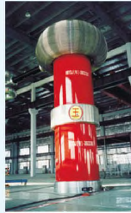
HRYDJ(W)-1500kVA/0~1500kV (交直流)工频无局部放电试验变压器全自动试验装置
