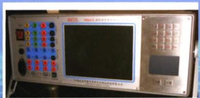
★HRWJC微机继电保护综合测试仪装置
