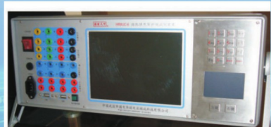
HRJFD现场数字局部放电检测分析系统 测量通道: 2通道 检测灵敏度: 0.1PC 测量频带: 3dB宽带10~300kHz 程控滤波器设置档位
