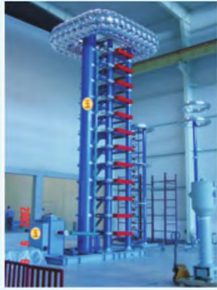
HRHG-1000~10000kV成套冲击电压发生器全自动试验装置
