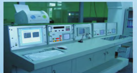
HRKZT(Q)和HRHGCS:采用PLC计算机控制与测量(光纤传输光电隔离测控技术)全自动试验系统,能满足用户对冲击试验、工频试验和局部放电试验、直流试验等高压试验控制和测量的所有要求。
