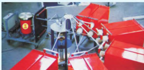
HRHG(A)-0.1~500kA成套冲击电流发生器全自动试验装置
