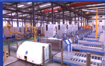
开关柜智能化生产线
