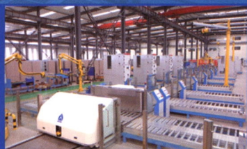
开关柜智能化生产线
