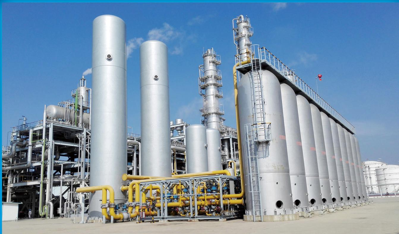
中海石油化学股份有限公司52000m<sup>3</sup>/h高压PSA法甲醇弛放气提纯氢气装置
