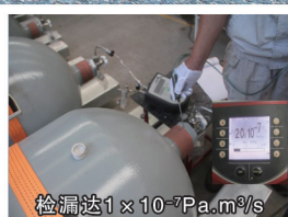
检漏达 1 \times 10^{-7} \text{Pa} \cdot \text{m}^3/\text{s}
