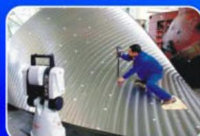
三峡700MW混流式叶片
