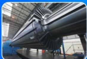
精加工发电机转子
