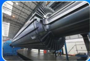
精加工发电机转子
