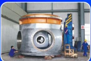
国内最大精度要求最高的轴流式转轮体
