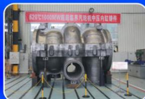
620°C 1000MW超高温超超临界汽轮机“中压内缸铸件（CB2材料）”
