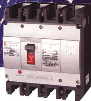
CM3DC系列塑料外壳式断路器额定绝缘电压1000V，适用于额定工作电压直流1000V及以下，额定电流16A~400A的电路中作不频繁转换之用。断路器具有过载、短路保护功能，能保护线路和电源设备不受损坏。
