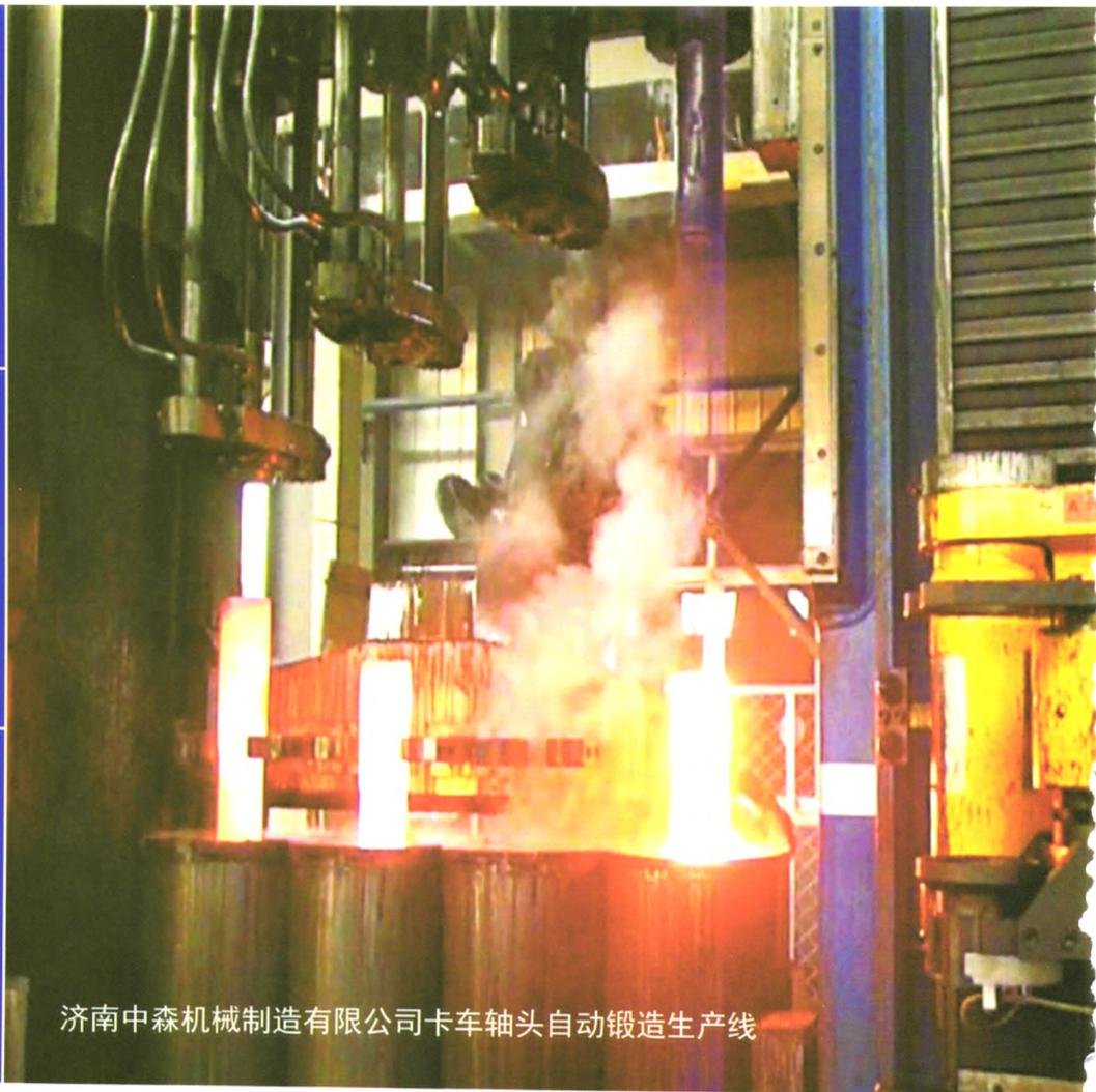
济南中森机械制造有限公司卡车轴头自动锻造生产线
