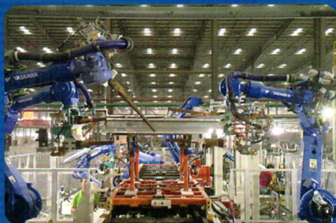
焊接机器人系统集成
