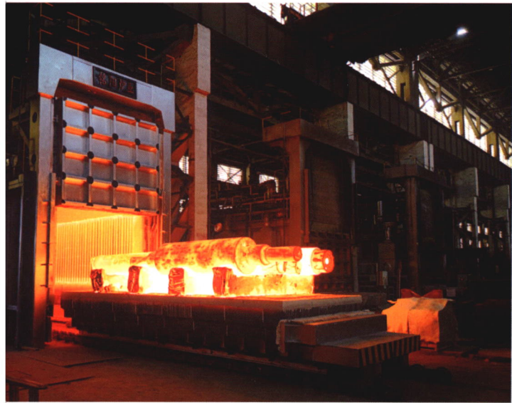
台车式硅碳棒锻造加热炉 2019年12月投产使用
