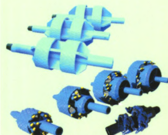
基岩非开挖钻进 扶正器和截齿回扩钻头
