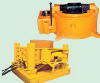
Lz500转盘和用于全套管钻进的回管机
