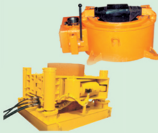
Lz500转盘和用于全套管钻进的回管机
