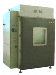
高加速寿命试验和应力筛选系统(halt & hass) 多激励多轴电动振动试验系统
