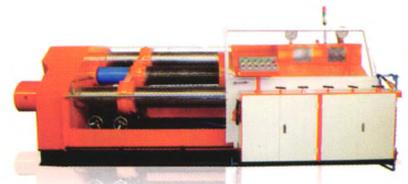
PZ-1000型 阀门压力测试机
