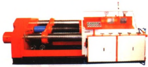
PZ-1000型 阀门压力测试机 (螺杆顶压式, 配电脑PLC 控制及液滴检测系统最高水压120MPa)
