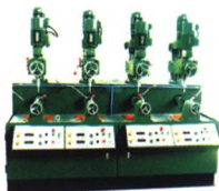
QTMJ-80型 多头球体 研磨机 (配变频调速)
