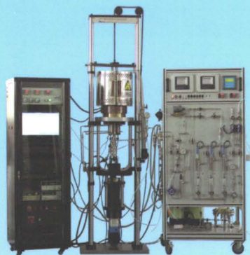
高温高压 超临界水应力腐蚀机型
