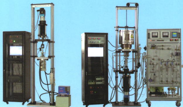
低温常压 气体、液体介质腐蚀机型 高温高压 超临界水应力腐蚀机型
