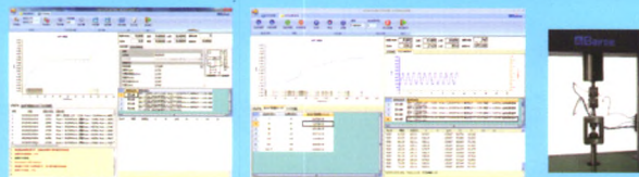
DCPD裂纹扩展速率测量系统
