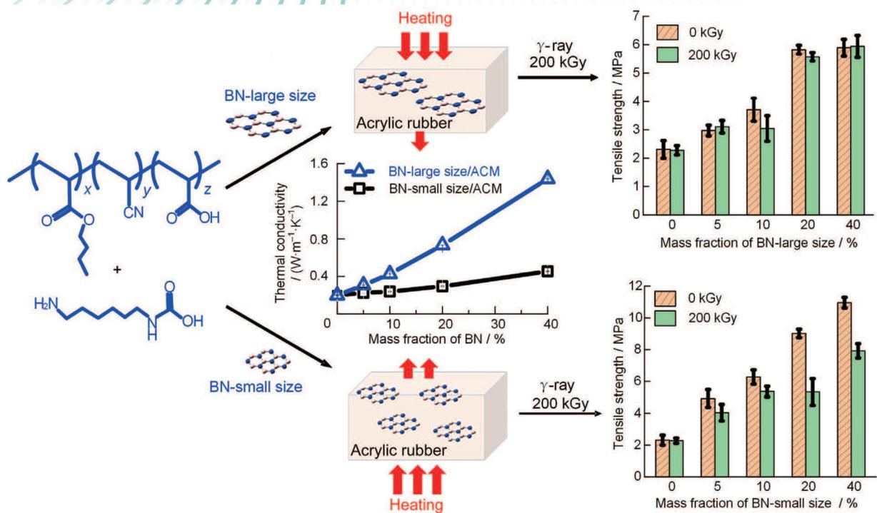
六方氮化硼/丙烯酸酯橡胶复合材料的导热性能和 $\gamma$ 射线辐射效应 (P.060201)
