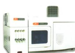
用于固体、液体样品中汞 (Hg) 和镉 (Cd) 的同时或分别分析测量，3~5 分钟时间就可以得到准确的分析结果，可应用于野外、现场应急监测等特殊环境
