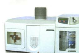
采用在线色谱分离—原子荧光检测法进行形态分析，可实现 As、Se、Sb、Hg 等元素的形态测定，并可双道同测 As、Se 和 As、Sb
