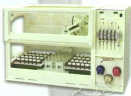
可一站式完成消解样品时的酸液添加、消解、赶酸、冷却、定容、混匀和转移等操作，适用于 ICP、AAS、AFS 等检测设备的样品预处理工作
