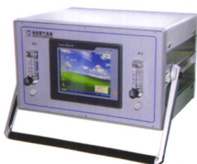
气体检测仪在线配气系统 ▲
