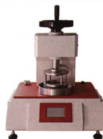
YG812D型织物渗水性测定仪
