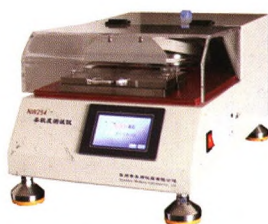
NW254型柔软度测定仪
